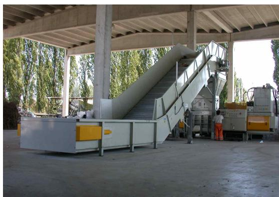
La catena è del tipo a rulli secondo norme DIN 8165.
