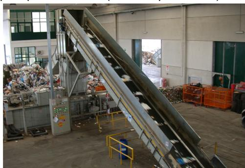
La struttura è composta da elementi modulari in lamiera pressopiegata bullonati, sulla quale sono fissati i rulli di sostegno e di guida del nastro; tale sistema rende facili sia le operazioni di trasporto, che quelle di montaggio.
